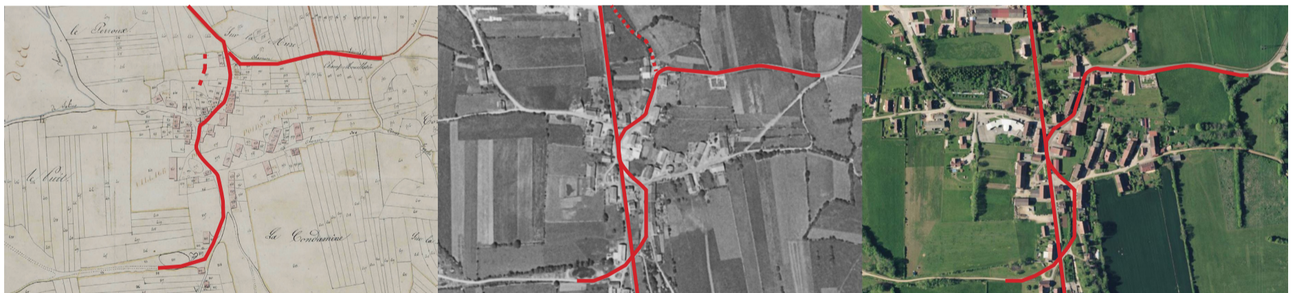
Transformation des voies de desserte et adaptation du système parcellaire à Poids de Fiole : la création de la ligne du Tacot, puis son abandon ont fortement modifié la structure viaire du village - cadastre Napoléonien et Photographie aérienne IGN 1962 et 2017
